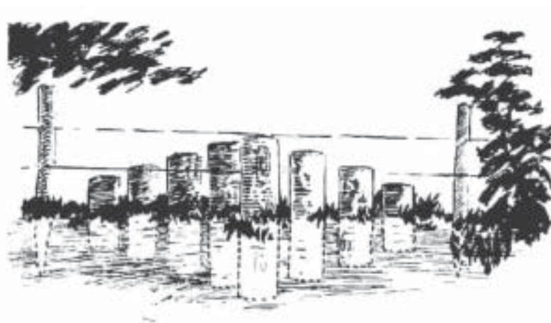
Tranquera de troncos enterrados
