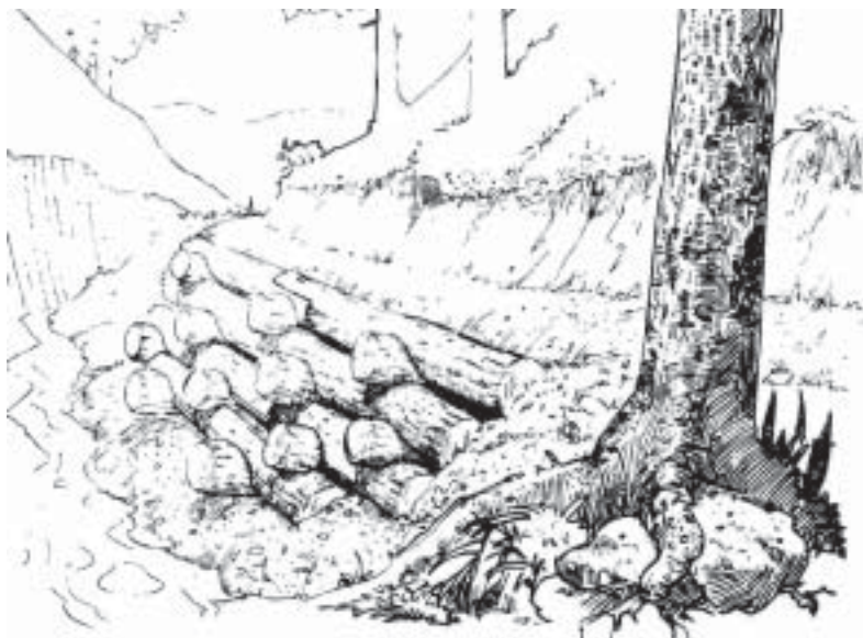
Pared de retención de troncos
